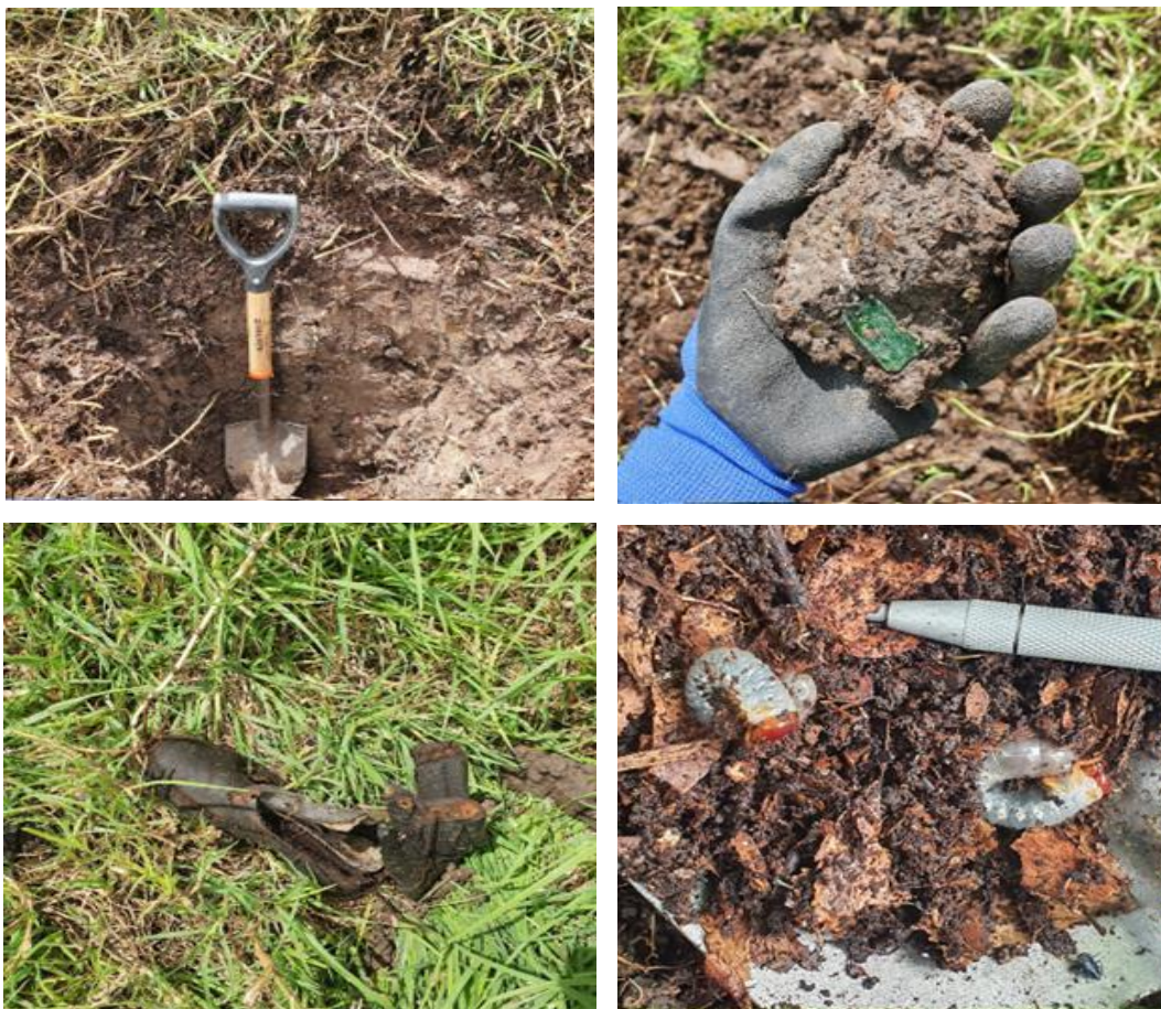
Figura 38. Calicata del sector 1. Arriba izquierda: Calicata levantada de 80cm de profundidad. Arriba derecha: Matriz de color en húmedo pardo oscuro, textura franco-arenosa, presencia de vidrios y plásticos. Abajo izquierda: Presencia de desechos de basuras como restos de ropa y zapatos. Abajo derecha: Presencia de insectos en estado larval de coleópteros. Fotografía de: Néstor Novoa, SPPA – SDA, 2022.
