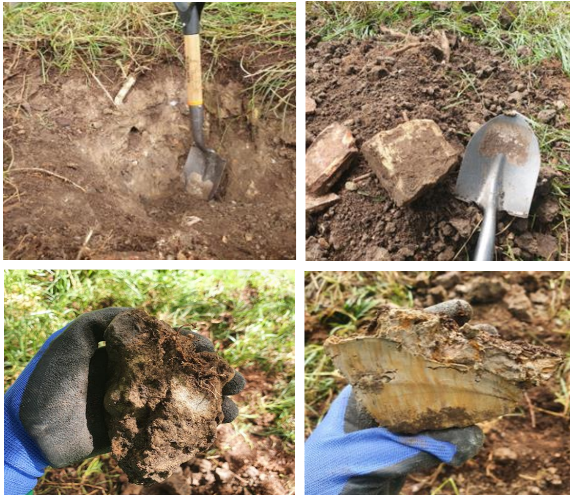
Figura 37. Calicata del sector 2. Arriba izquierda: Calicata levantada de 50 cm de profundidad. Arriba derecha: Escombros de construcción. Abajo izquierda: Matriz de color en húmedo pardo oscuro, textura franco-arenosa. Abajo derecha: Matriz con color en húmedo amarillo parduzco, textura arcillosa. Fotografía de: Néstor Novoa, SPPA – SDA, 2022.
